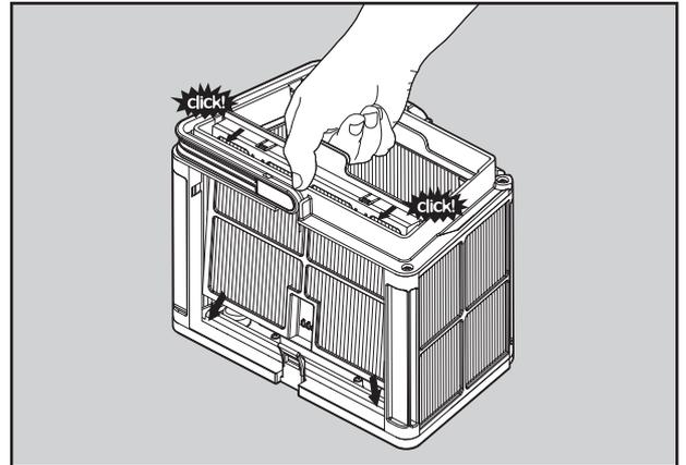
Montieren Sie die Filterplatten.
