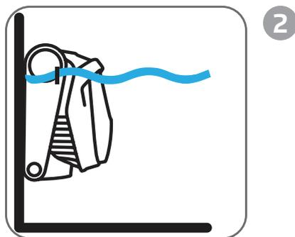
Nach ein paar Sekunden steigt der Roboter zur Wasseroberfläche und wartet dort 60 Sekunden lang, bis er eingeholt wird.
