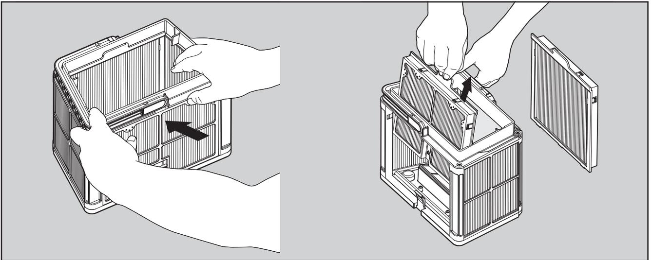
Demontieren Sie die zwei Platten mit den Daumen.
