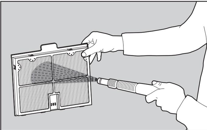
Reinigen Sie die Filterplatten mit einem Schlauch.
