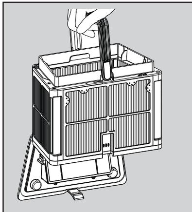
Öffnen Sie die Verriegelung, um den Bodendeckel zu entriegeln und Ablagerungen zu entfernen.
