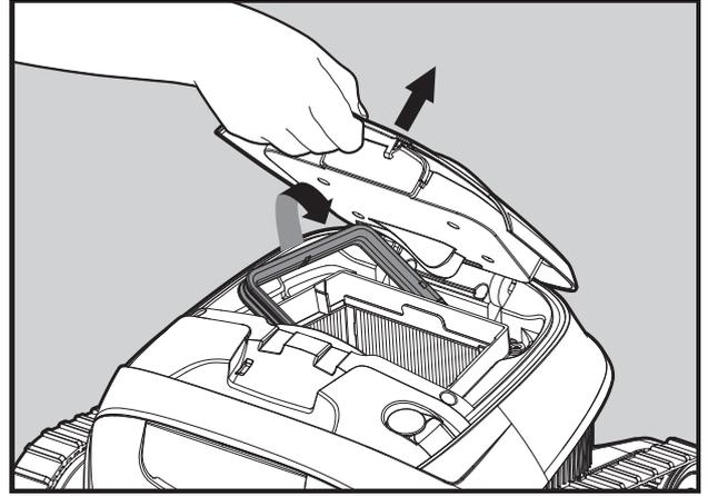
Beim Öffnen des Filterdeckels hebt sich der Griff selbstständig an.
