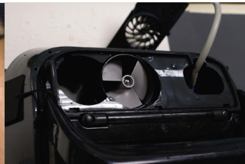
7.2 Reinigen Sie den Impeller.. 7.3 Das Schutzgitter einsetzen.
